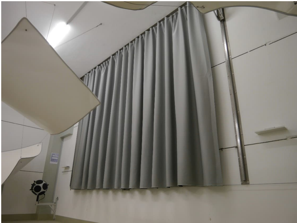
Abbildung B.2. Geraffte Prüfanordnung im Hallraum (seitliche Ansicht).
